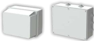
Diferentes grados de protección (IP44, IP55 e IP65) que garantizan su instalación en exteriores. Fabricados de material termoplástico y policarbonato. Amplia gama de dimensiones, con y sin knockouts.
